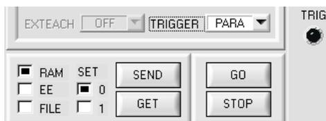
Der Zustand von IN0 wird auf der Oberfläche durch die LED **TRIG** angezeigt. Ist die LED schwarz, dann ist IN0=LO=0V und der Sensor arbeitet mit Parametersatz 0.
